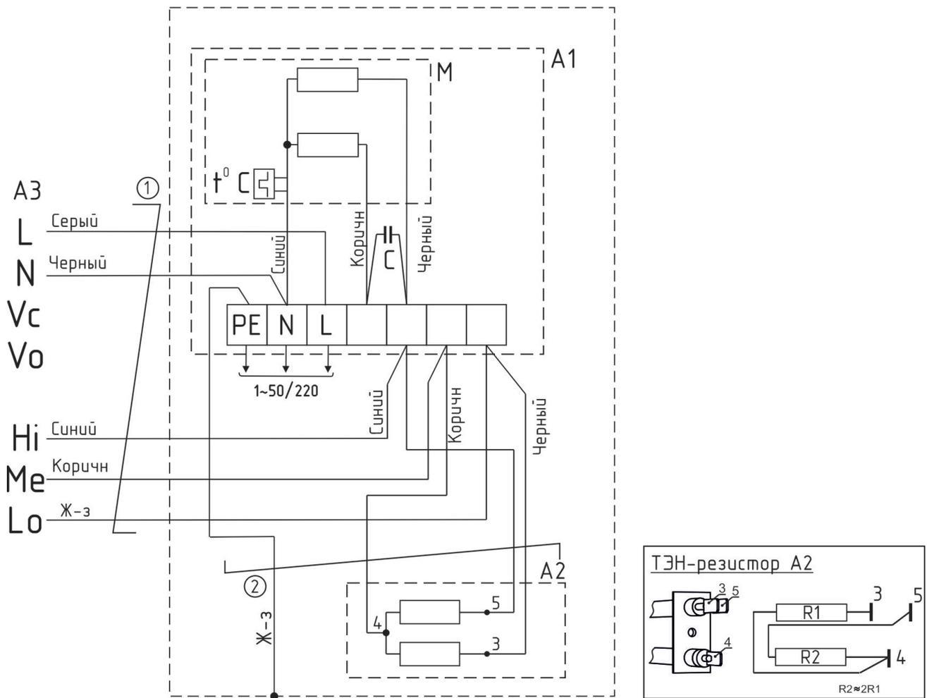
Рисунок 9 – Схема электрическая КЭВ-3Ф, КЭВ-5Ф, КЭВ-6Ф, КЭВ-7Ф, КЭВ-8Ф, КЭВ-10Ф, КЭВ-11Ф, КЭВ-13Ф, КЭВ-16Ф, КЭВ-17Ф, КЭВ-18Ф, КЭВ-21Ф, КЭВ-24Ф
