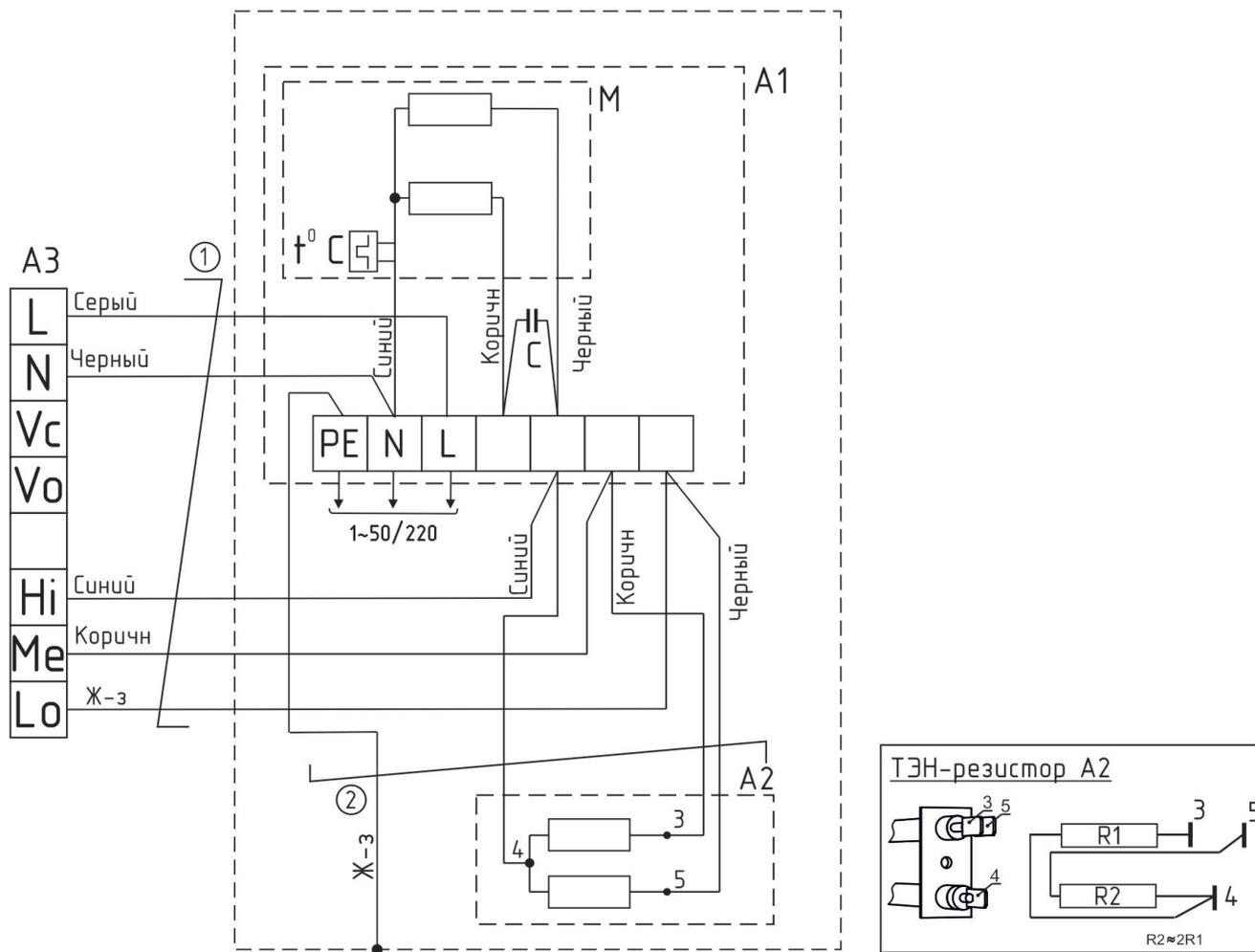
Рисунок 10 – Схема электрическая КЭВ-28Ф5,6ПМ
